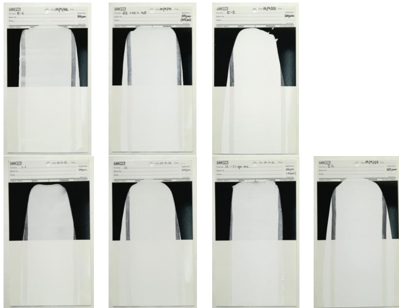
Figura 10. Aplicaciones sobre cartulina de contraste para la determinación de la relación de contraste de los recubrimientos de exterior E1, E2 y E3 (arriba de izquierda a derecha) y recubrimientos de interior I1, I2, I3 e I4 (debajo de izquierda a derecha).
