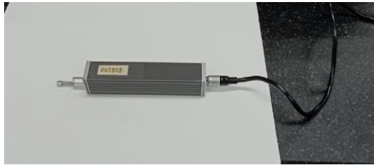
Figura 21. Equipo medición de la rugosidad superficial, concretamente se observa el palpador.
