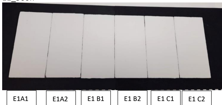
Figura 13. Aspecto del recubrimiento E1 inicialmente y tras 500h de envejecimiento artificial.
