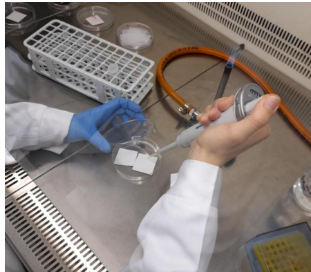
Figura 20. Ensayo microbiológico. Inoculación de bacterias sobre recubrimiento de ensayo.
